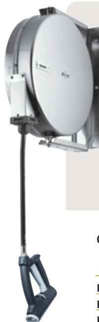
► MAXIREel. Gruppo doccia basculante a parete con tubo estraibile a riavvolgimento automatico. Tubo in gomma alimentare. Idropistola mod. "Nito-2". Involucro inox AISI 304.
