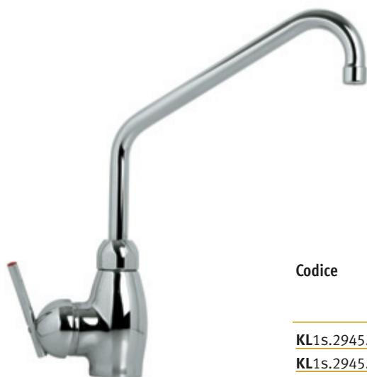
> Rubinetto monoforo da banco mod. "LCL" e gambo di fissaggio (lunghezza 50mm). Tubetti d'alimentazione diametro 10x1mm con raccordi M1/2". Cartuccia miscelatrice grande portata. Leva monocomando mod. "LCL". Canna girevole in ottone cromato mod. "LCL".
