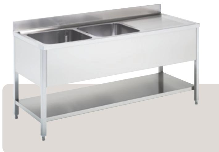
› Lavelli su gambe nella profondità 600 mm nelle lunghezze da 600 a 2.100 mm, ad una vasca e due vasche con e senza gocciolatoio, completi di pilette e troppopieni e ripiano inferiore rinforzato. A richiesta possono essere dotati di laterali (dx-sx). Realizzati in acciaio inox AISI 304 (Cr-Ni 18/10) per garantire la conformità alle norme igieniche.
