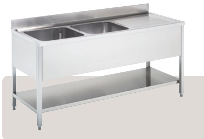
› Lavelli su gambe nella profondità 700 mm nelle lunghezze da 600 a 2.500 mm, ad una vasca e due vasche con e senza gocciolatoio, completi di pilette e troppopieni e ripiano inferiore rinforzato. A richiesta possono essere dotati di alzatine laterali (dx-sx). Realizzati in acciaio inox AISI 304 (Cr-Ni 18/10) per garantire la conformità alle norme igieniche.
