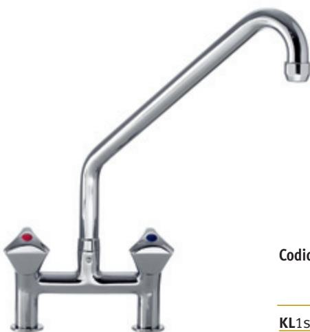
➤ Rubinetto biforo da banco inclinato. L'inclinazione in avanti delle manopole consente l'installazione vicino alla parete o all'alzatina del lavello. Gambi di fissaggio lunghezza 50 mm con interasse 155 mm. Manopole mod. "3P". Vitoni 3/4". Canna d'erogazione girevole in ottone cromato.
