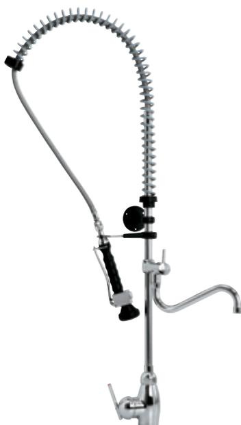
› Gruppo doccia prelavaggio stoviglie su monoforo da banco monocomando mod. "LCL". Gruppo doccia con rubinetto aggiuntivo "RST". Gambo di fissaggio 3/4" (lunghezza 50 mm). Tubi d'alimentazione 10x1 mm con raccordi M 1/2". Cartuccia miscelatrice grande portata. Leva monocomando mod."LCL". Leva mod."LCL-RST" e vitone ceramico 1/2" su rubinetto aggiuntivo. Canna d'erogazione a "S" girevole diametro 20 mm.
