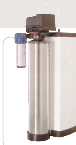
**RG20AT NON CABINATO** > Addolcitore automatico non cabinato. Bombola d'acciaio inox AISI 304 capacità 20 litri. Portata massima 1.500 l/h. Raccordi rapidi per il collegamento alla salamoia. Raccordi per la connessione idrica 3/4" con miscelatore. Sale per rigenerazione 3,5 kg. >> Cartuccia e filtro non compresi
